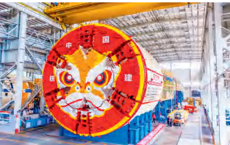
2021年8月，中国铁建重工集团股份有限公司自主研发的我国最深海底隧道盾构机“深江1号”下线。
