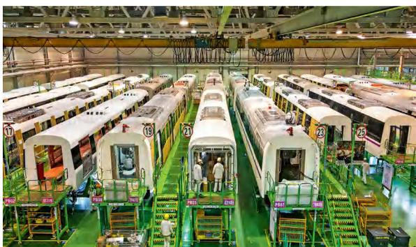
中车株洲电力机车有限公司城轨总装车间工人正在组装列车。
