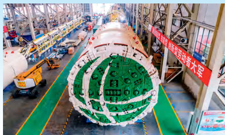
全球首台可变径斜井岩石隧道掘进机“天岳号”。
